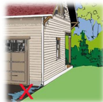
Déversement de l'eau sur une surface imperméable inclinée vers la rue (entrée asphaltée)
